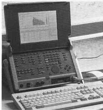
Moderne Messtechnik: Zweikanaliger Echtzeitanalysator (Fotos: Step)
