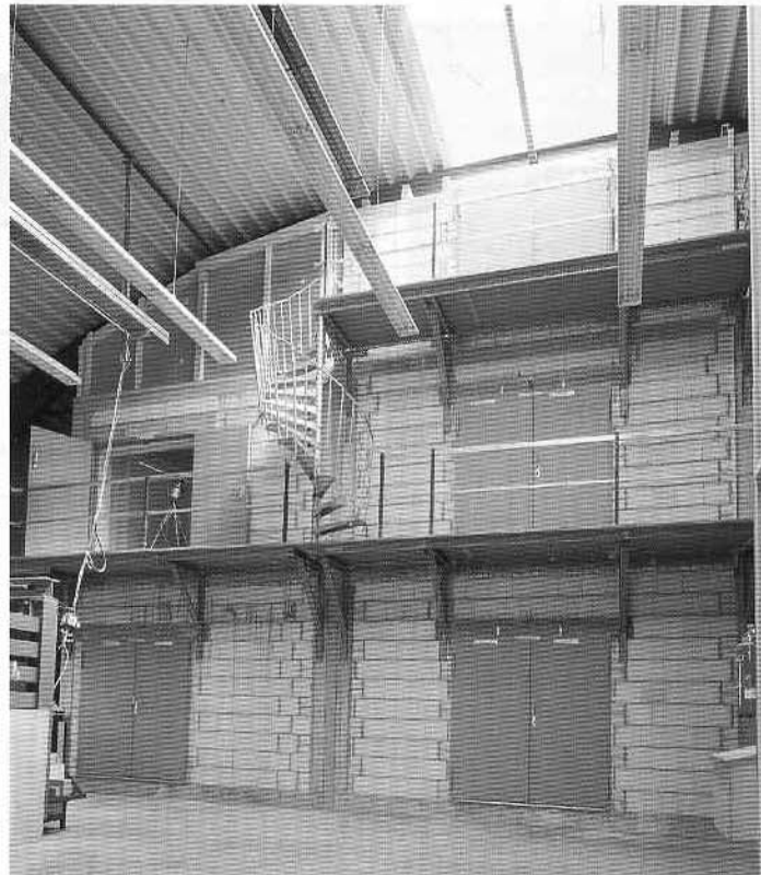
Teilansicht des mehrgeschossigen schalltechnischen Treppenprüfstandes der Step GmbH; links: Senderäume für Massivwände; Mitte: Empfangsräume, rechts (nicht im Bild): Senderäume für Leichtbauwände
