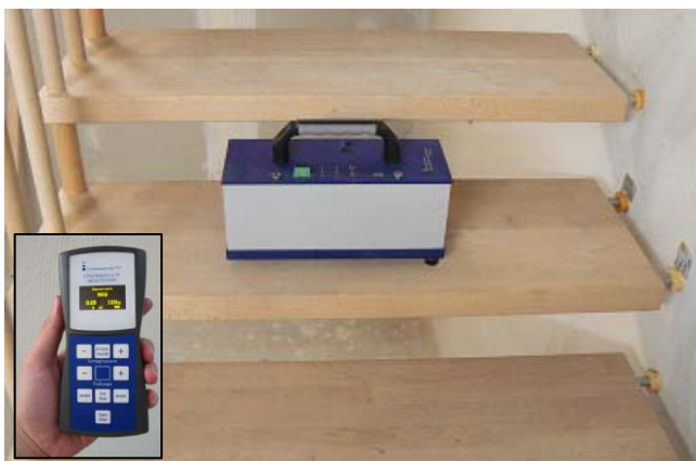
Abbildung 1: Das neue elektrodynamische Hammerwerk mit Fernbedienung
