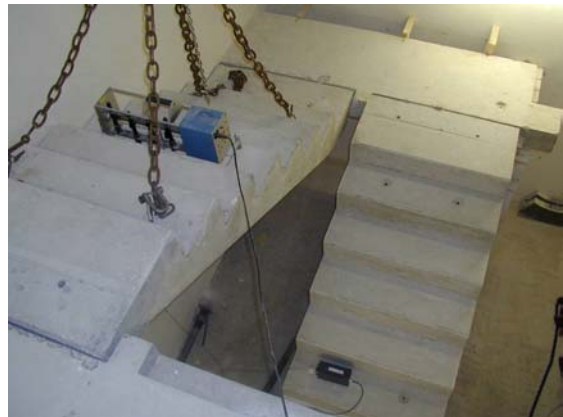
Abbildung 1: Versuchsaufbau - entkoppelte Laulagerung
